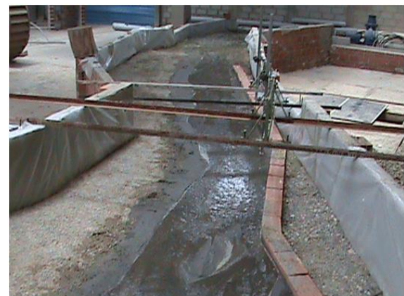
Figura 2. Modelo terminado con estructuras de protección
