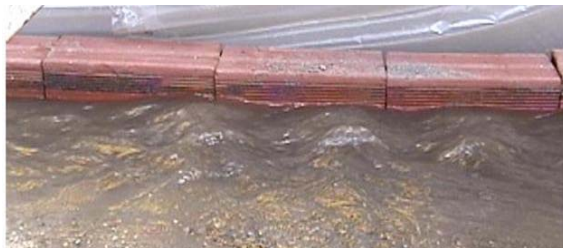
Figura 3. Superficie ondulada del flujo cerca del muro defensivo
