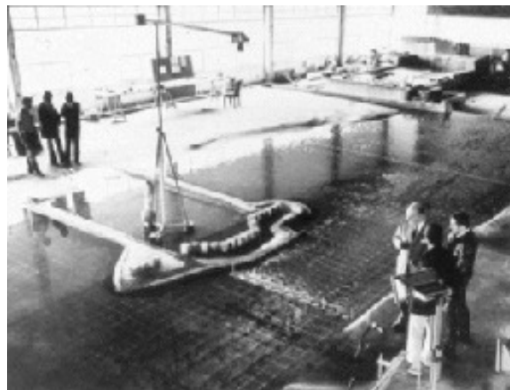
Figura N° 1. Modelo del río Uruguay en Salto Grande
