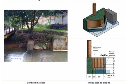
**Figura 1.-** Propuesta de diseño para la protección de las raíces de un árbol de mango en la margen derecha de la quebrada. Zona alta del parque lineal La Presidenta.
