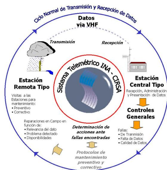
Figura 2: esquema de funcionamiento del Sistema Telemétrico
