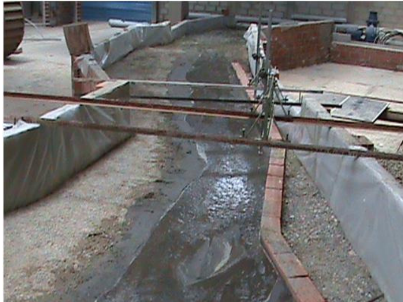
Figura 6. Modelo terminado con lecho final y estructuras de protección, Agosto 2010
