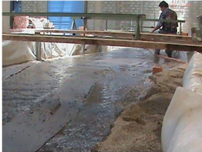
Figura 22. División del flujo aguas arriba. Foto mirando hacia aguas abajo
