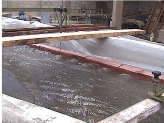
Figura 12. Ondulación de superficie pegada a la porción media del muro defensivo
