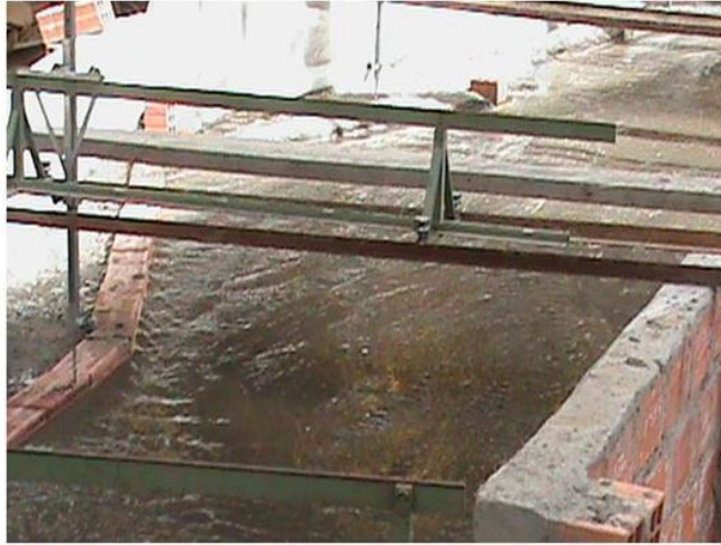
Figura 19. Ondulación de superficie a lo largo de la porción superior del muro y deflexión parcial del flujo en el quiebre
