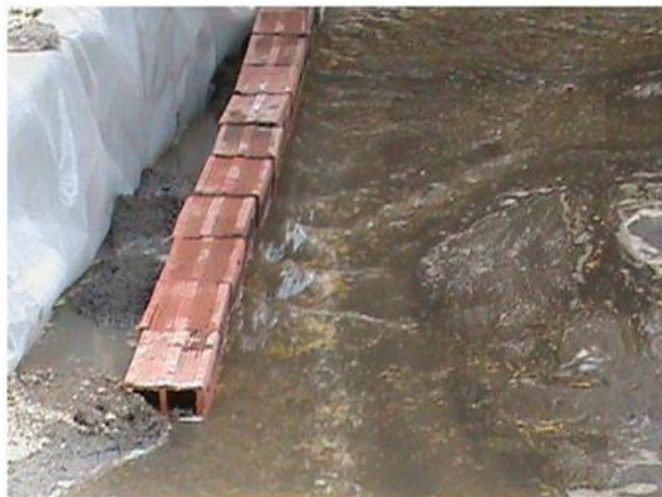
Figura 21. Ondulaciones y concentración del flujo a lo largo de la porción inferior del muro
