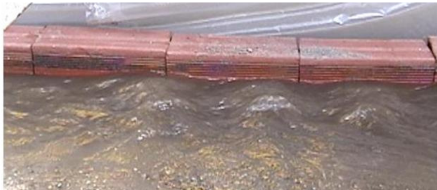
Figura 9. Superficie ondulada del flujo cerca del muro en el tramo intermedio, cerca del angostamiento
