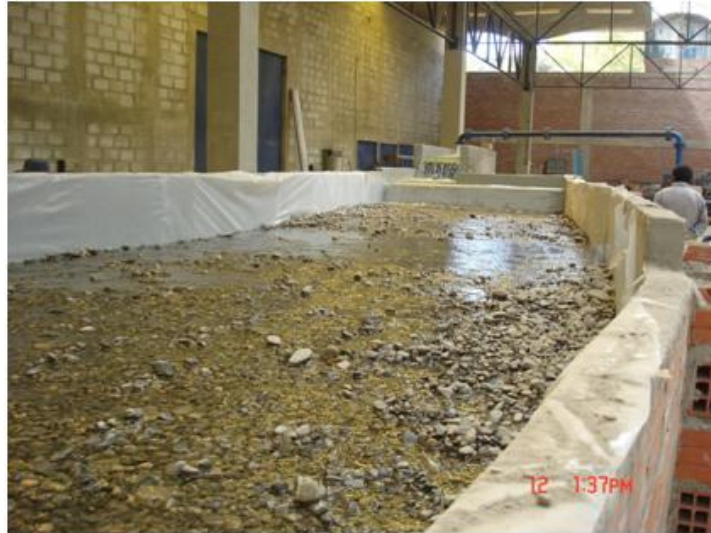
Figura 5. Lecho del modelo sobre el fondo de grava
