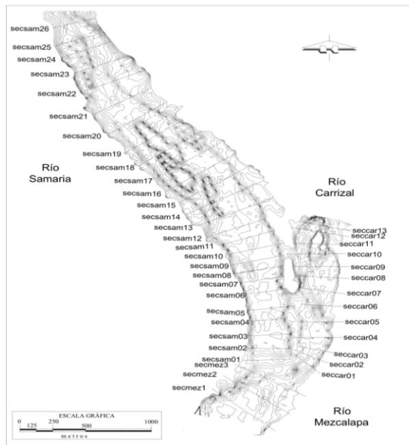
**Figura 6.-** Localización de las secciones transversales levantadas
