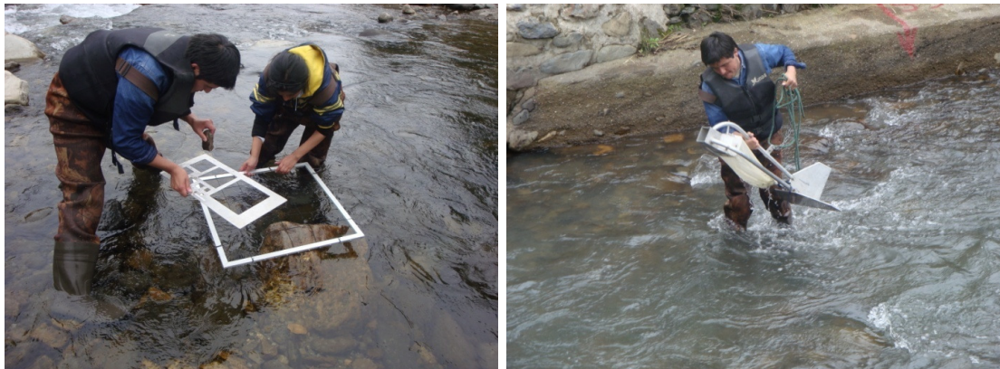
Figura 2.- Muestreo espacial con el marco metálico propuesto por Bunte & Abt (2002) y un muestreador Helley-Smith siendo usado en el río Santa Isabel
