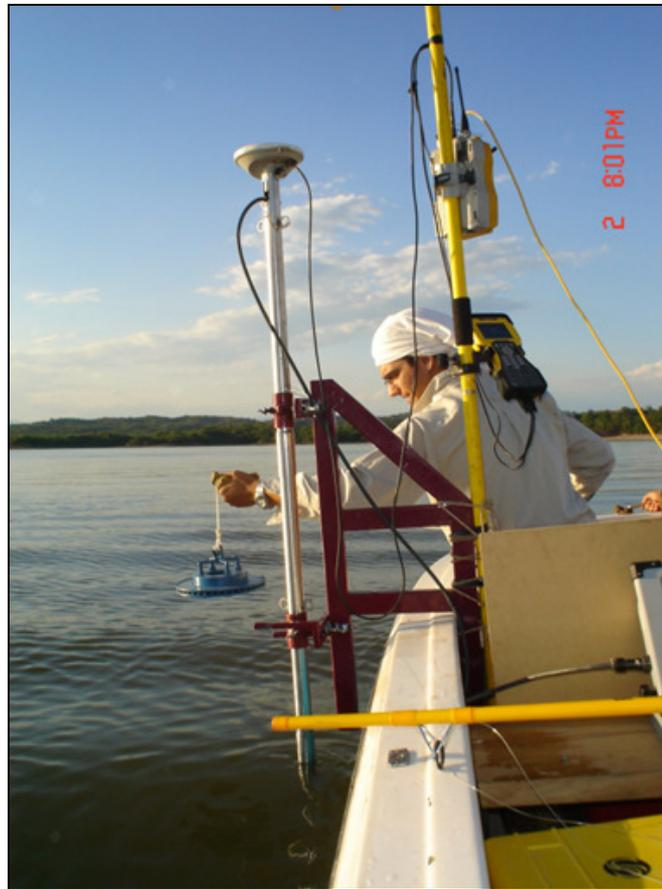
**Figura 6.-** Elemento utilizado para calibrar profundidad medida de la ecosonda
