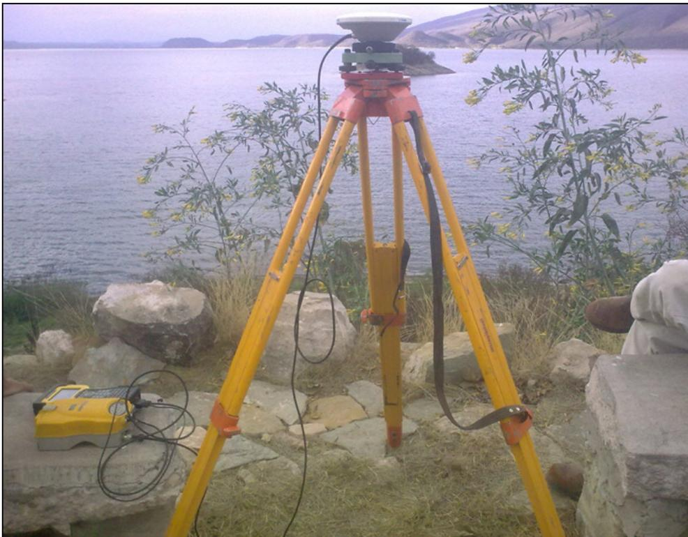
**Figura 2.-** Equipo GPS Trimble 5700 utilizado (Rover, Receptor, antena y trípode).
