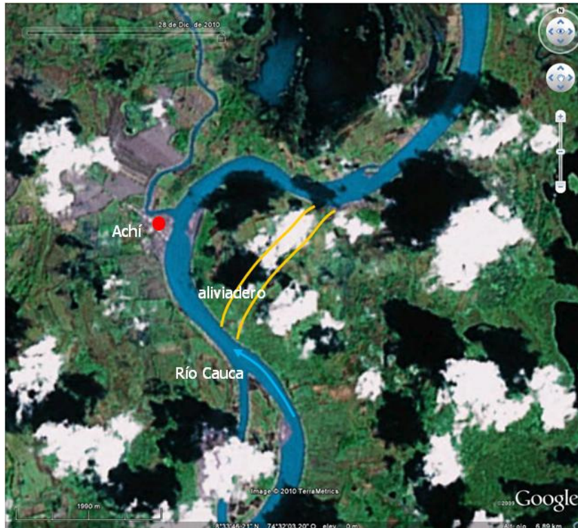
Figura 12.- Aliviadero frente a Achí, que no solo ayudaría a abatir el nivel sino que además permitiría evacuar más rápido la creciente
