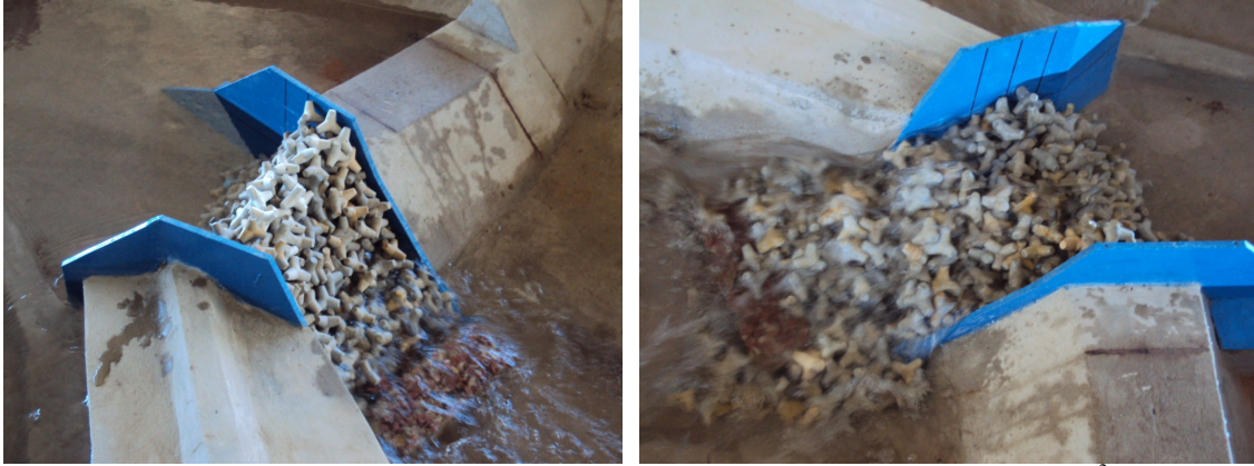
Fotografías 8 y 9: Cierre Bío Bío – Colapso del terraplén para Q= 2500 \text{ m}^3/\text{s} .
