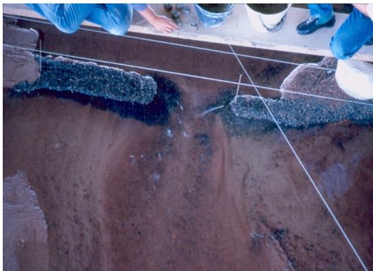
Fotografías 3 y 4: Modelo y prototipo del desvío del río Limay en Piedra del Águila
