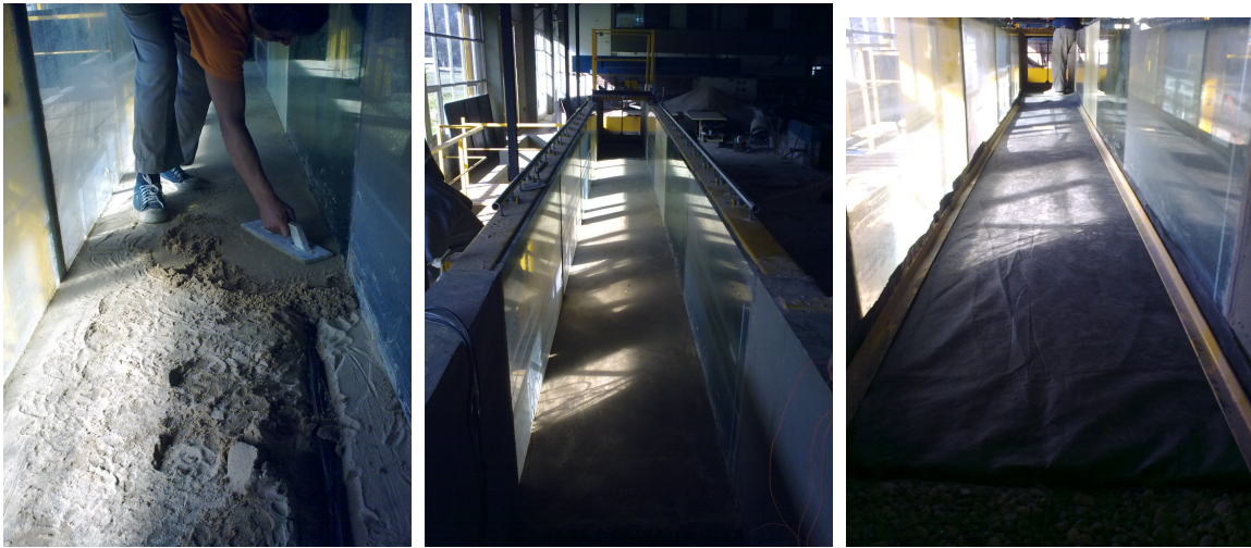
Figura 3.- Nivelación de la arena de base y configuración final del canal, previa a las experiencias
