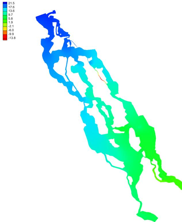
**Figura 7.-** Distribución de concentraciones [g/l]. Condición de crecida, caudal  $3201\text{m}^3/\text{s}$ . Con secado de malla
