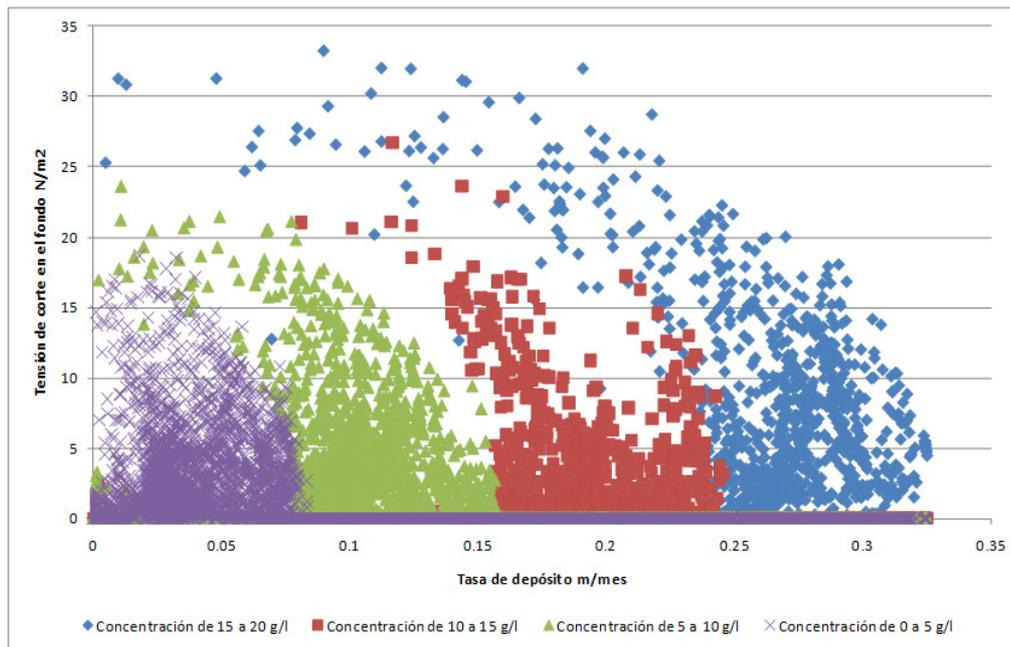
**Figura 8.-** Pares de valores “tensión de corte en el fondo – tasa de deposición” en función de la concentración. Corrida  $Q=1715 \text{ m}^3/\text{s}$   $C_0=20 \text{ g/l}$ .
