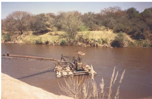
Figura 2: Balsa con bomba aspirante trabajando en el cauce del Río Segundo, tramo Plujunta
