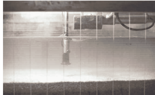
Figura 3.- Equipamiento ultra-sonográfico – C-meter – utilizado para el registro del fondo del escurrimiento
