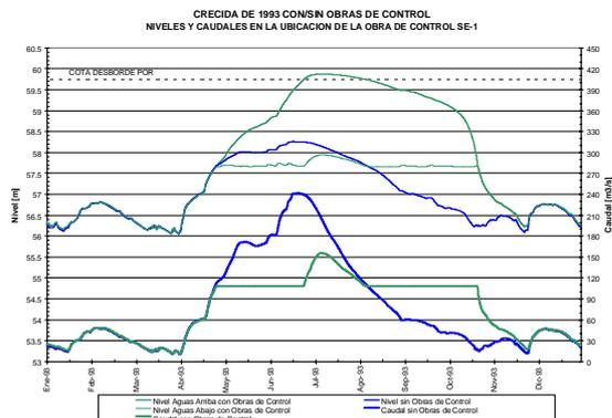
Figura Nº 5.- Ejemplo de regulación de Caudal en una OC
