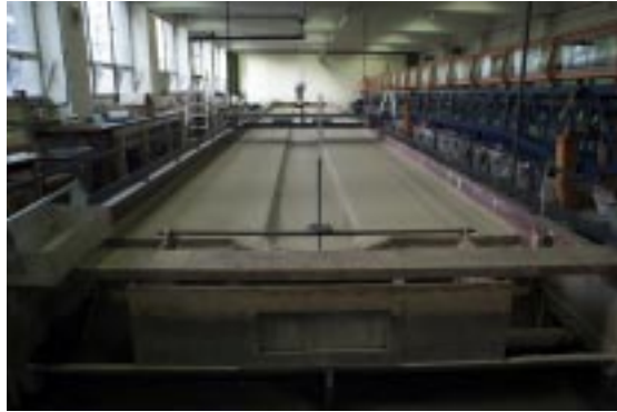
Figura 1.- Canal alisado, condición inicial de ensayo.
