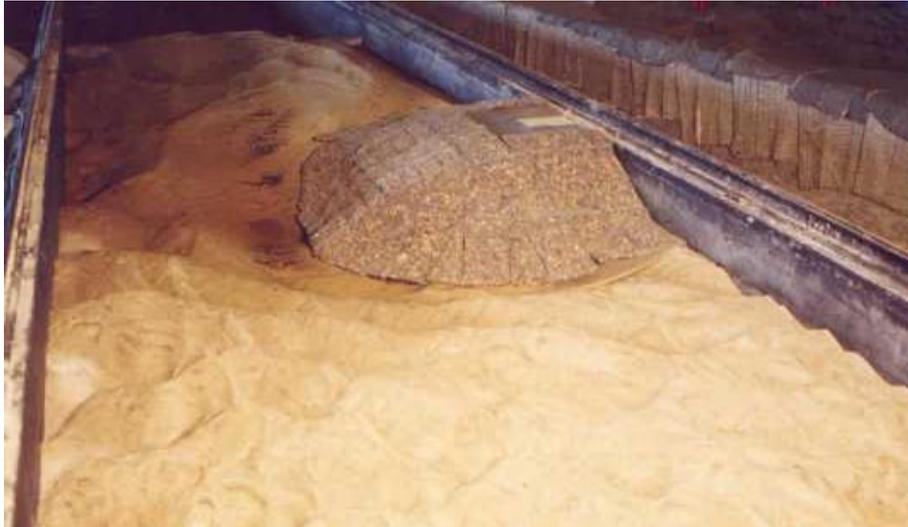
**Figura 12.-** Modelo físico a fondo móvil – Estribo protegido con colchonetas de alambre rellenas con piedras.
