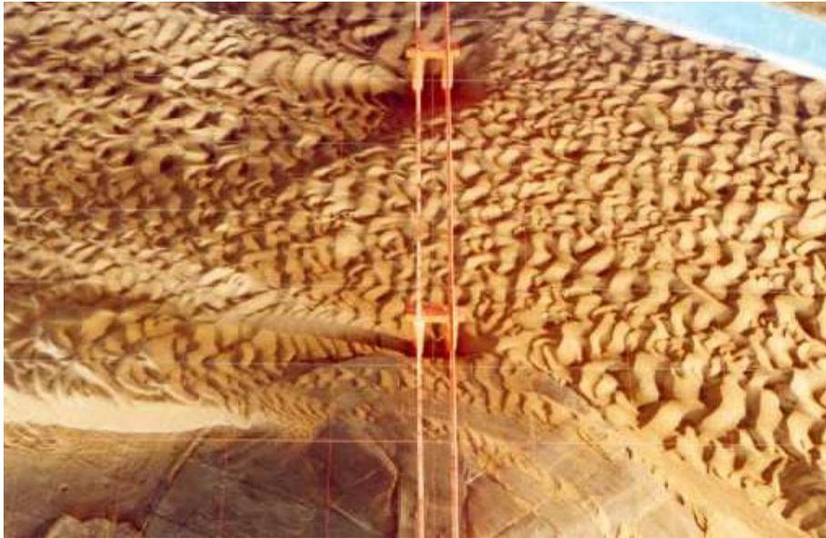
**Figura 10.-** Modelo físico a fondo móvil.
