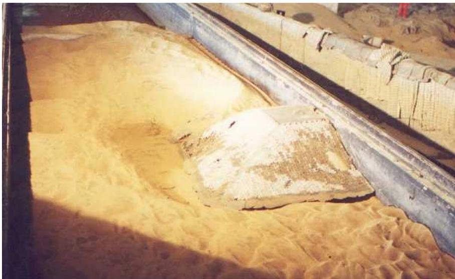
**Figura 13.-** Modelo físico a fondo móvil – Estribo protegido con bloques intertrabados.
