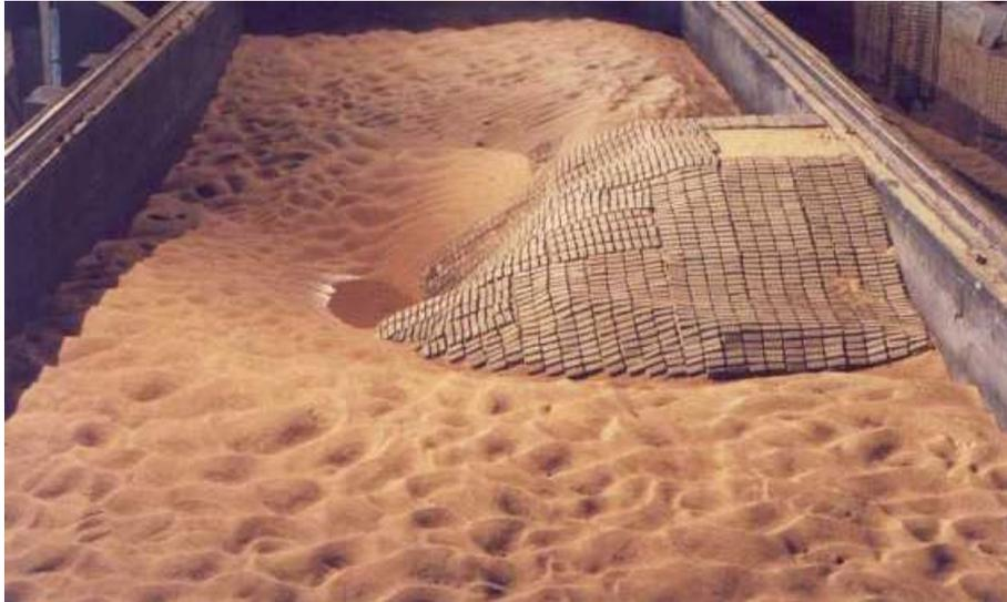
**Figura 14.-** Modelo físico a fondo móvil – Estribo protegido con bloques de hormigón adheridos a geotextil.
