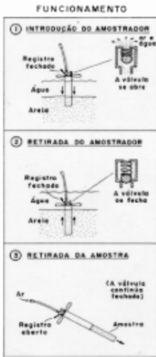
Figura 11.- Funcionamiento del Colector de Muestras (Wilson-Jr, 1987, 2002)
