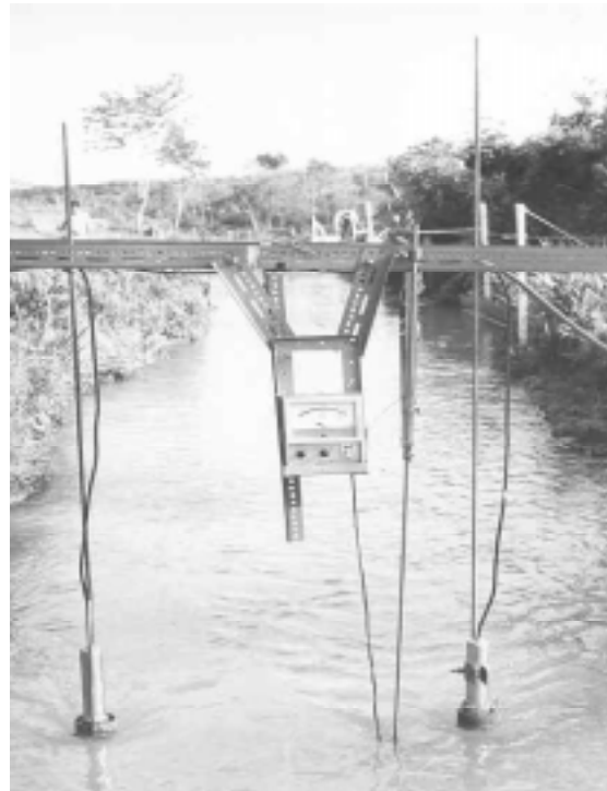
Figura 20.- Registrador del Espesor de Agua, al Centro, en el Carro de Detección Longitudinal del Arroyo Horácio. (Wilson-Jr y Paiva, 2003)
