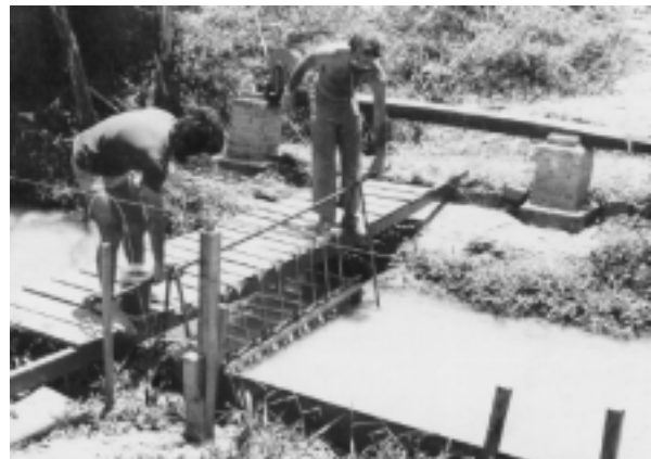
Figura 7.- Inyección de los Sedimentos Radioactivos en el Arroyo Horácio (Wilson-Jr, 2002)
