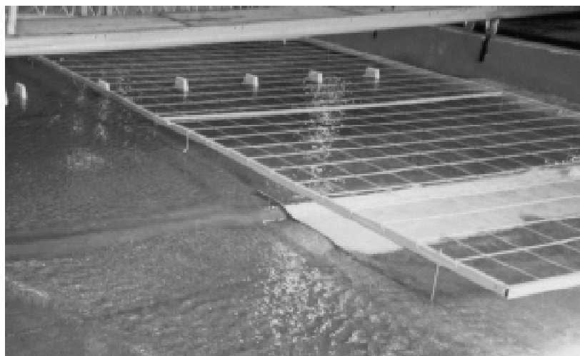
Figura 5: Modelo físico tridimensional del Azud del Puente Carretero.
