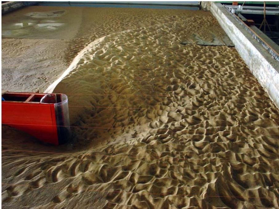
**Figura 5.-** Configuración final del fondo móvil del modelo físico. Ensayo:  $Q=385$  lt/s,  $h=25$  cm.
