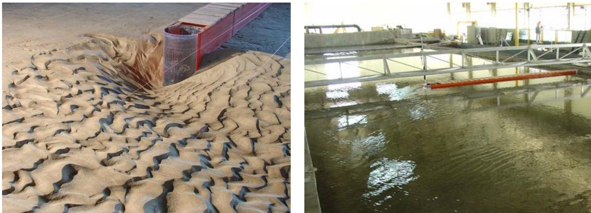
Figura 2 - Modelo Físico luego de concluidos dos ensayos. Conformación final del fondo móvil erosionado.
