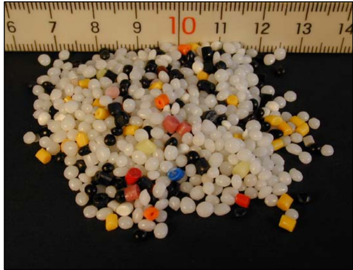
Figura 3.- Diferentes materiales sintéticos para la simulación de sedimentos finos en modelos físicos.
