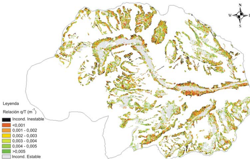
Figura 12.- Mapa raster con los resultados de la aplicación del modelo Shalstab. Se indican los valores de la relación q/T clasificando el grado de estabilidad de las laderas.
