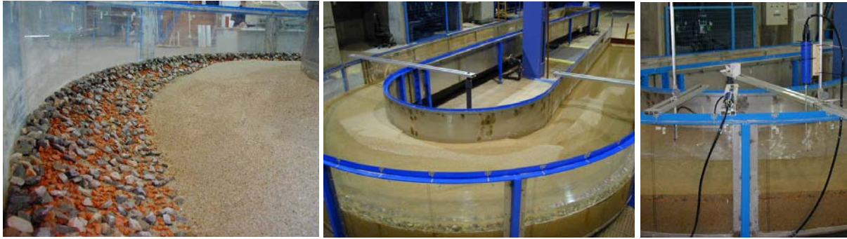
Figura 2.- Izquierda y centro, protección de margen flexible y rígida respectivamente en el modelo experimental. Derecha, medición de velocidades con ADV tridimensional y bidimensional.
