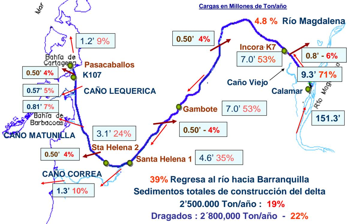
Figura 6.-Balance sedimentológico de la Alternativa 4, con control del caudal
