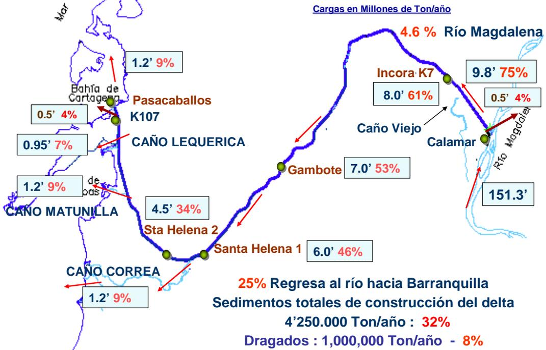
Figura 5.-Balance sedimentológico de la alternativa 3, sin control del caudal
