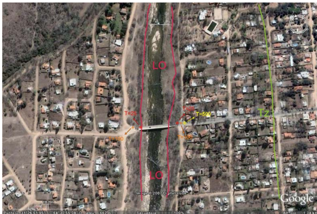
Figura 8 -Sección San Antonio-vado, indicando el trazado del LO, las Tz y los puntos que alcanzarán crecidas de recurrencia 25, 100 y 500 años.
