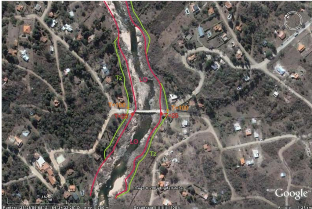
Figura 4. -Sección Cuesta Blanca, indicando el trazado del LO, las Tz y los niveles que alcanzarían crecidas de recurrencia 25 y 100 años.
