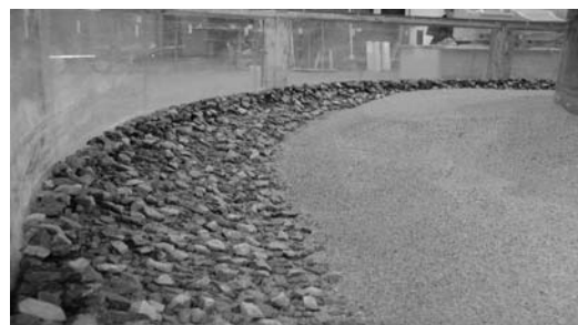
Figura 4.- Protección de margen en el modelo experimental.
