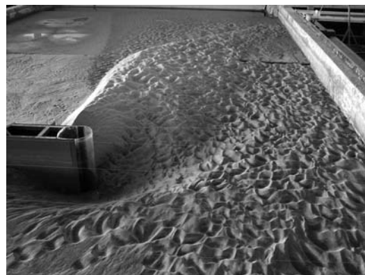
Figura 3.- Configuración final del fondo móvil Ensayo: Q=385 lt/s, h=25 cm.
