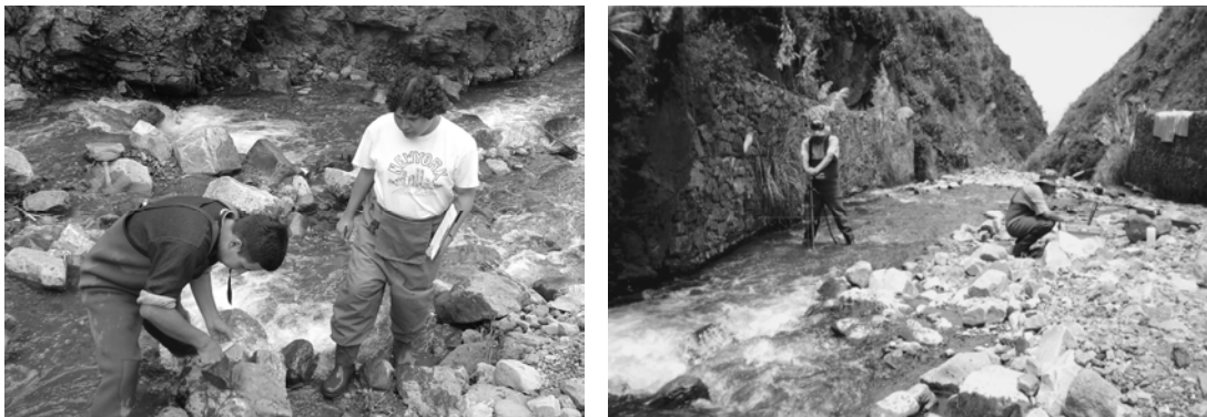
Figura 2.- Aplicación del método de muestreo de Wolman (1954) y medición de caudales con un ADV
