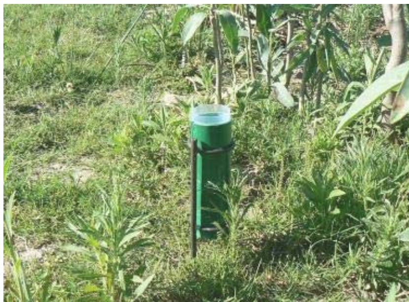
Figura 2.- Ejemplo de TSed instalada con soporte de hierro.
