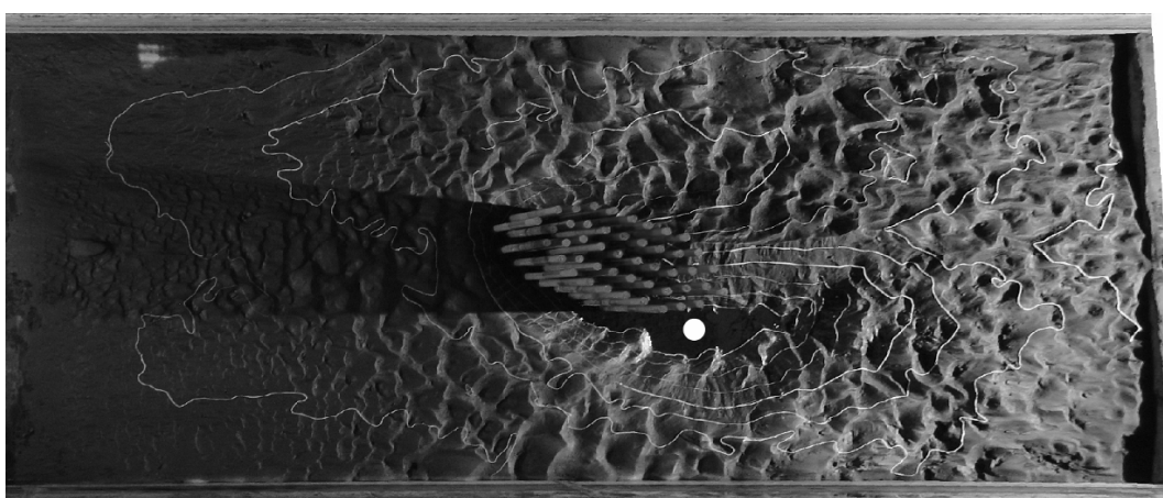
Figura 8.- Planta del modelo con la indicación del punto de mayor profundidad en blanco. 46 pilotes; tirante = 0.32 m; U = 0.291 m/s; ángulo = 20^\circ .
