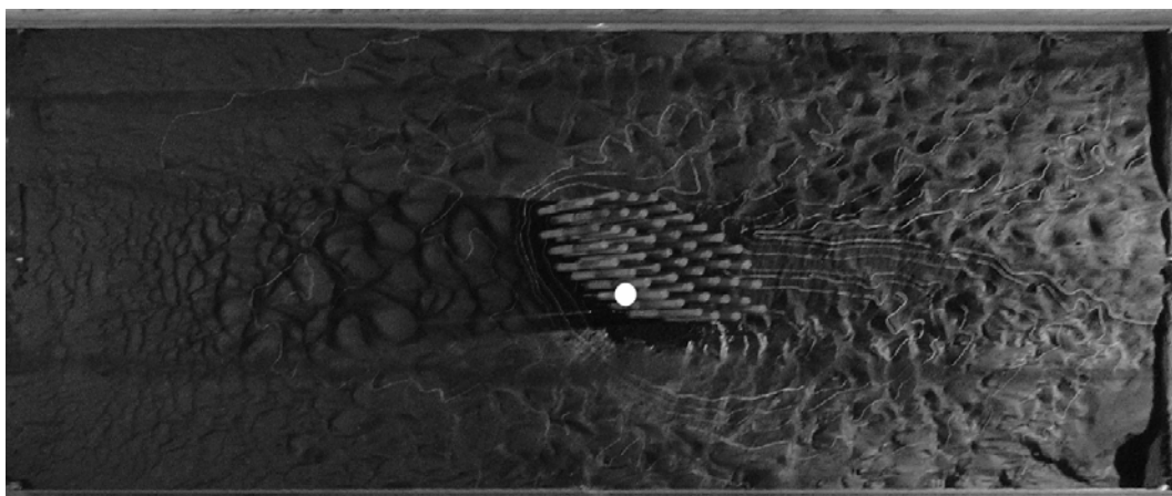
Figura 9.- Planta del modelo con la indicación del punto de mayor profundidad en blanco. 46 pilotes; tirante = 0.32 m; U = 0.291 m/s; ángulo = 30^\circ .
