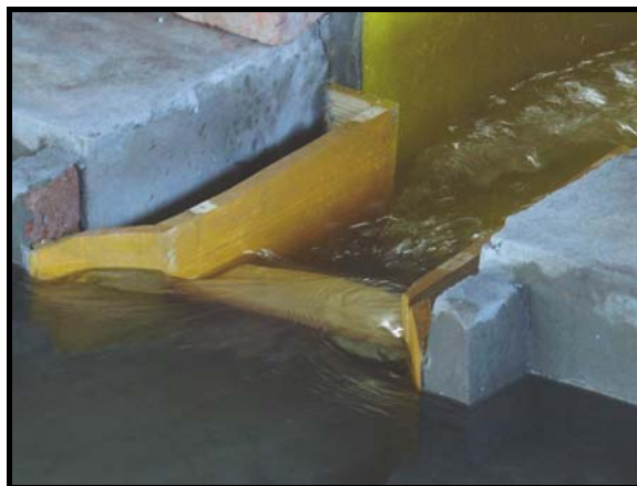
Figura 3.- Vista general del modelo en la etapa de Diagnostico. Capacidad del puente carretero Q: 700 m 3 /s
