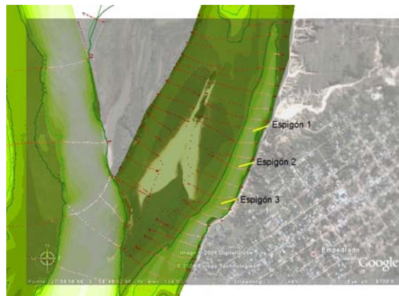
Figura 6.- Esquema de espigones
