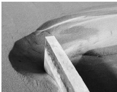
Figura 4.- Hoya de erosión resultante en el ensayo E_R .
