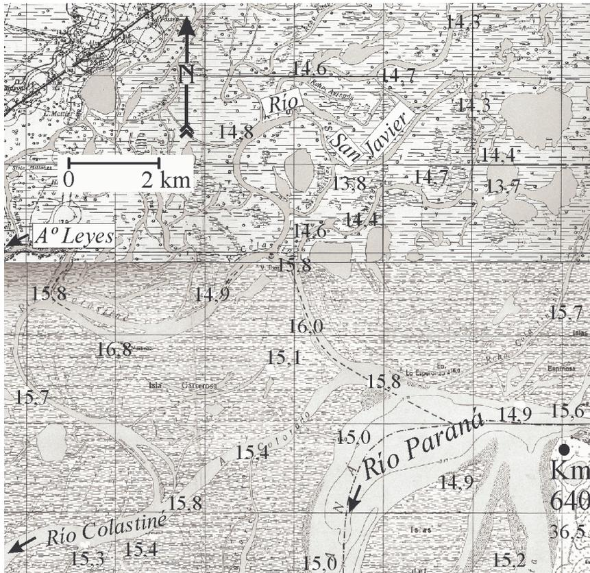
**Figura 3.a.-** Mosaico topográfico del área de estudio realizado con las cartas 3160-27-1 y 3160-27-2 del IGM. Las cotas corresponden a un relevamiento expeditivo realizado en la década del '60, donde se pone de manifiesto el resalto topográfico a uno y otro lado de la alineación Cerrito-arroyo Leyes.
