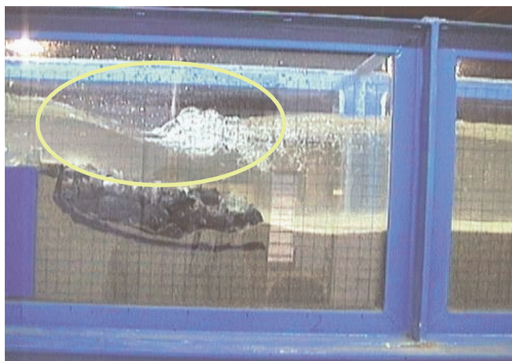
Foto 1.- Resalto hidráulico aguas abajo del cuenco disipador.
