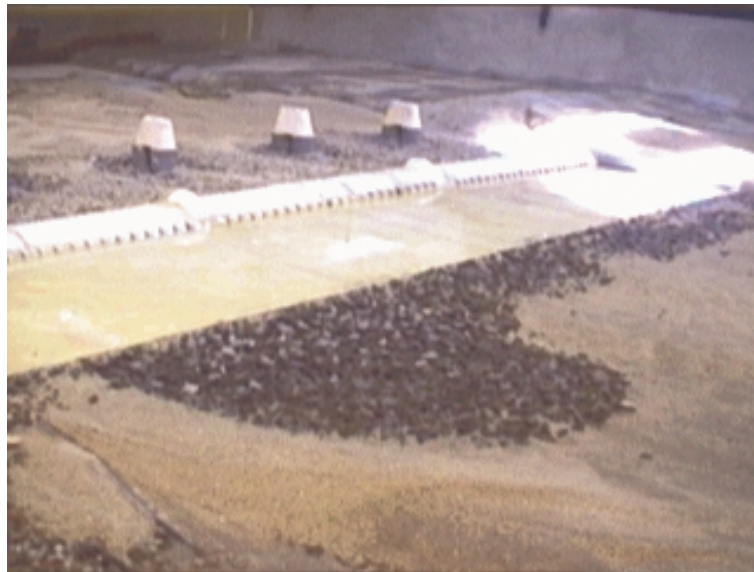
Foto 2.- Erosión final aguas abajo del APF. Ensayo: E8_APF_2900.
